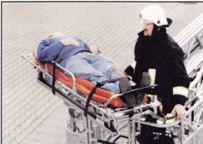
Die Krankentragehalterung dient zur Unterstützung des Rettungsdienstes bei der Rettung von Personen, die einen schonenden Transport, aus höhergelegenen Stockwerken bedürfen.
