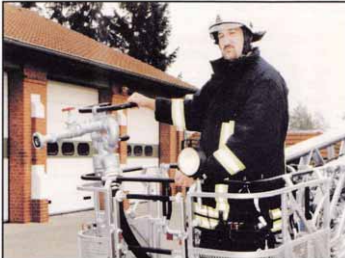
Das Wenderohr dient zur Brandbekämpfung mit einer Wasserdurchflussmenge von ca. 1600 Litern pro Minute.
