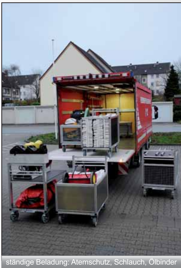
die Ladebordwand ermöglicht ein schnelles Umladen
