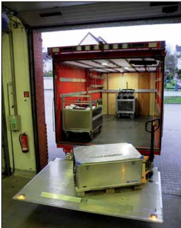
die Ladebordwand ermöglicht ein schnelles Umladen
