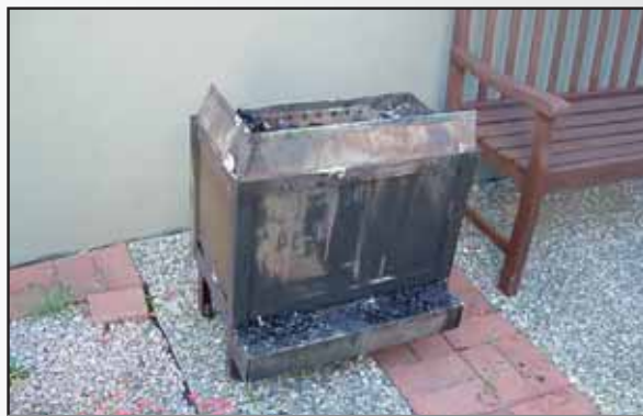
der Saunaofen - wahrscheinlich Brandursache
